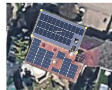
Modell einer 26,1 kWp PV-Anlage auf Ihrem Gebäude
